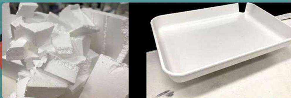
Figura 1. Desechos de a) PSE y b) RHIPS, empleados para la elaboración de las membranas.
