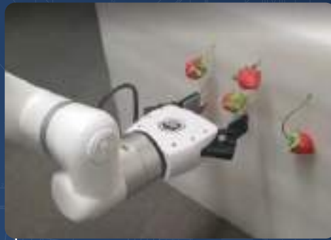
Figura 3. Prueba de desempeño de corte de tallos.
