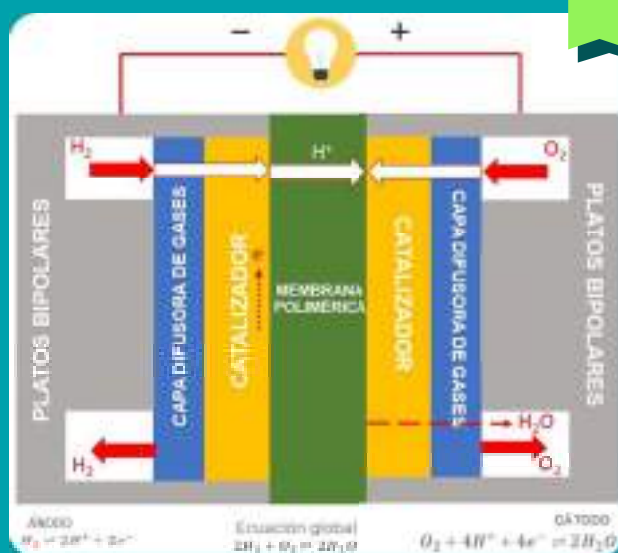
Funcionamiento de una celda de combustible tipo PEMFC.
